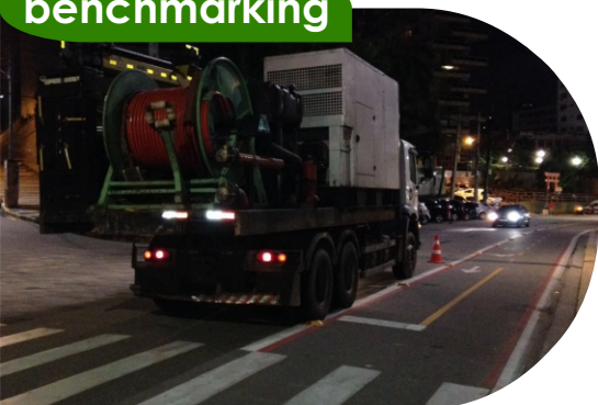
Equipamento utilizado pela Cagece para limpeza de interceptor
