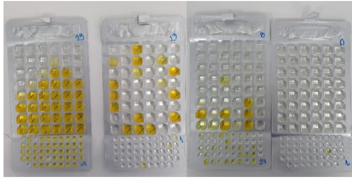
Figura 21. Remoção de coliformes, em sequência, afluente 2, efluente 2, efluente 2 com 5 e 10 mg/L de solução oxidante.
