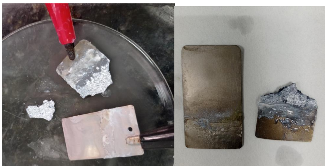
Figura 12 – Nível de oxidação do eletrodo de aço ao final do experimento.
