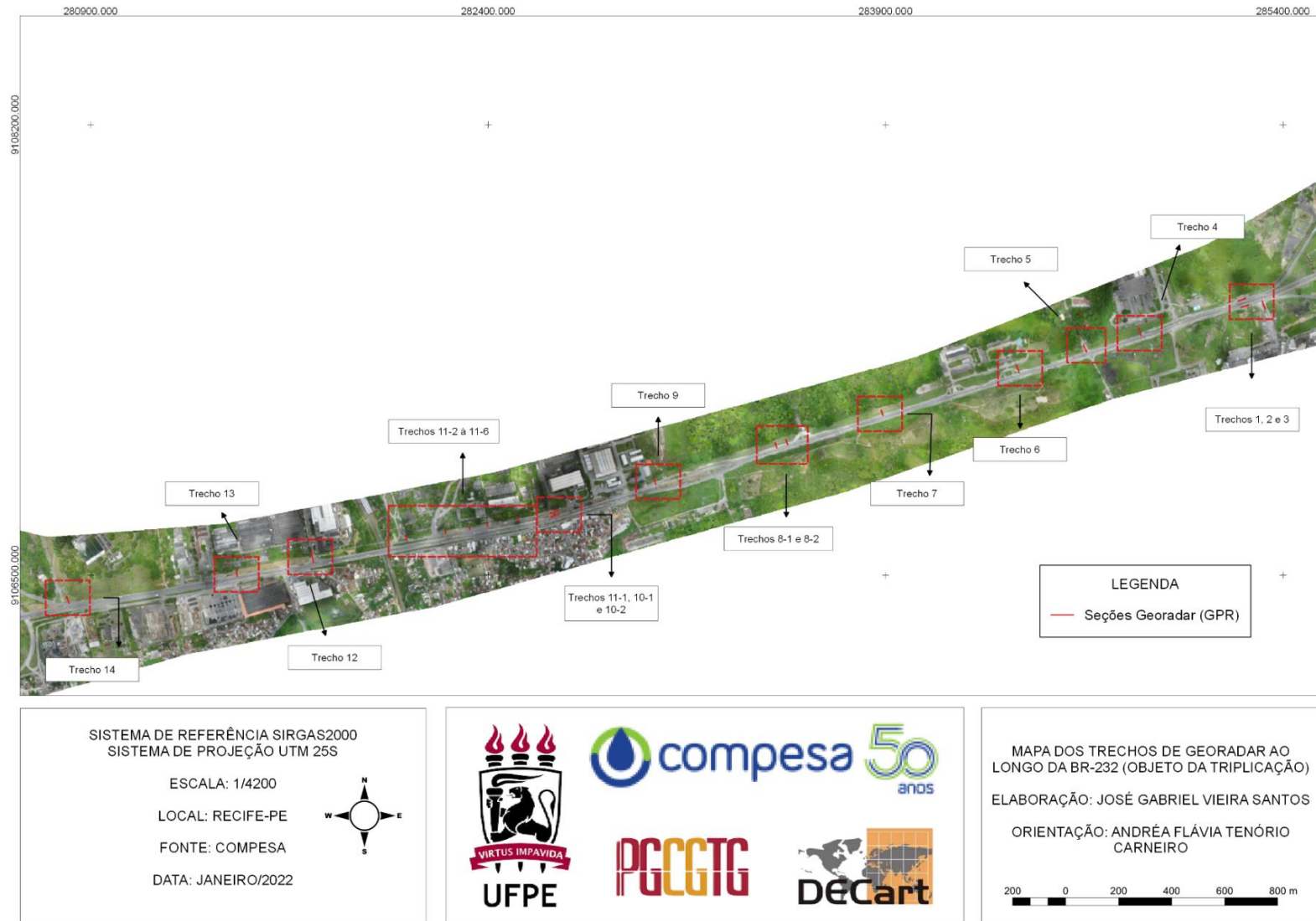
Figura 13 – Definição dos trechos de mapeamento por GPR
