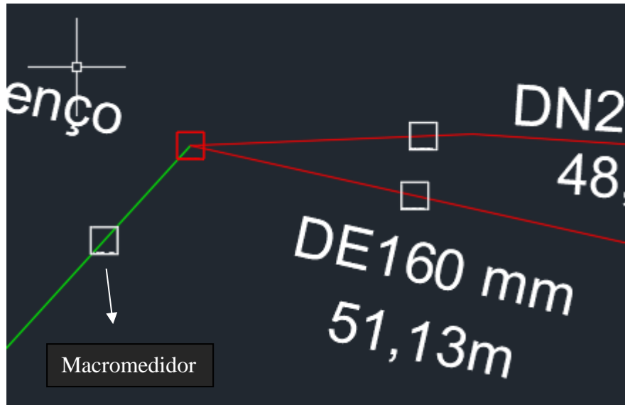
Figura 9 – Trecho de rede de abastecimento de água projetada para o município de Goiânia/PE, contendo macromedidores em formato de bloco no AutoCAD .
