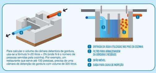
Para construir caixas adequadas à sua necessidade, procure a loja de atendimento da Compesa mais próxima e solicite a visita de nossos técnicos, que irão estudar o dimensionamento adequado para seu equipamento.
