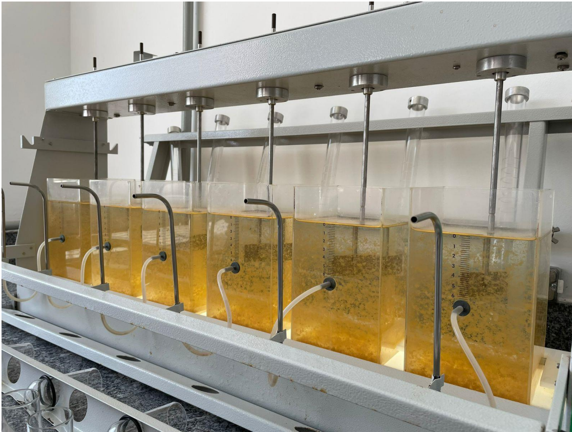
Figura 12: Foto do ensaio realizado com o aparelho de jartest no dia 19/11/24.
