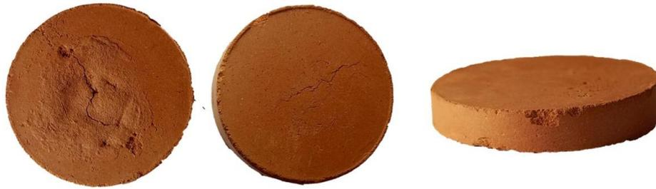
(a) Deformação na base e fissuras      (b) Variação da espessura
