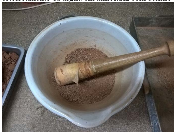
Figura 20 – Destorroamento da argila em almofariz com auxílio de mão de gral
