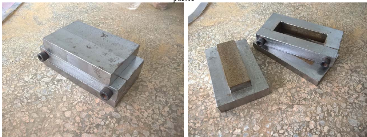
Figura 34 – Molde metálico para produção dos corpos de prova: a) molde montado; b) molde em 3 partes
