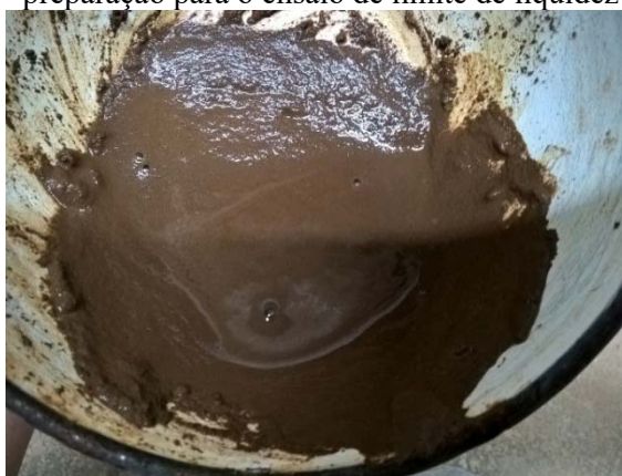
Figura 30 – Formação de película sobre a amostra de lodo coletado na ETA Pirapama durante a preparação para o ensaio de limite de liquidez
