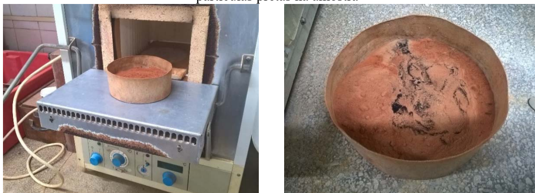
Figura 26 – Calcinação do lodo na mufla: a) lodo saído da mufla; b) detalhe do surgimento de partículas pretas na amostra
