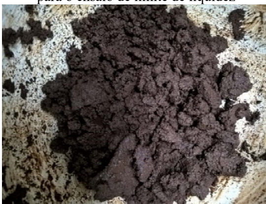
Figura 25 – Aspecto granular da amostra do lodo coletado na ETA Botafogo durante a preparação para o ensaio de limite de liquidez
