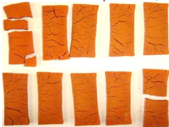
Figura 16 – Corpos cerâmicos confeccionados apenas com lodo, sinterizados à 950 °C
