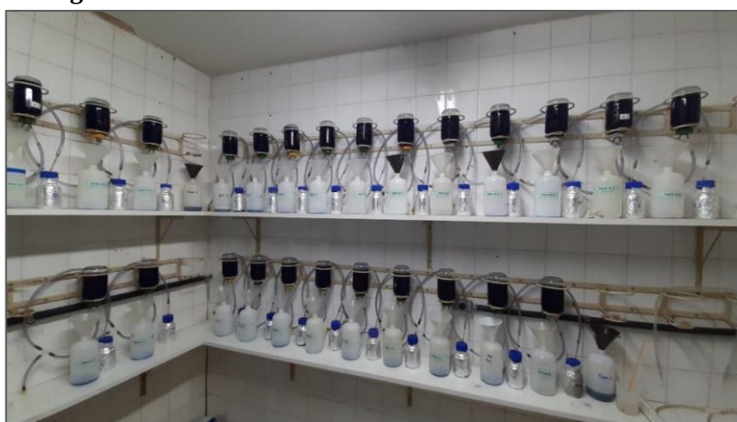
Figura 6 – Reatores instalados na sala termostatzada do LSA
