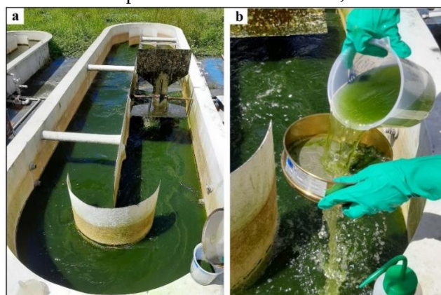
Figura 2 – Coleta de biomassa algal: (a) lagoa de alta taxa. (b) concentração da biomassa algal utilizando peneira com abertura de 0,250 mm
